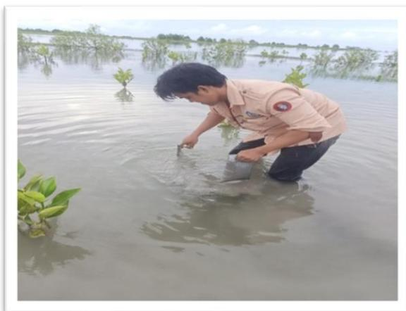
Gambar 2. Pengambilan sampel pada area sedimentasi muara sungai amamapare menggunakan sekop.
