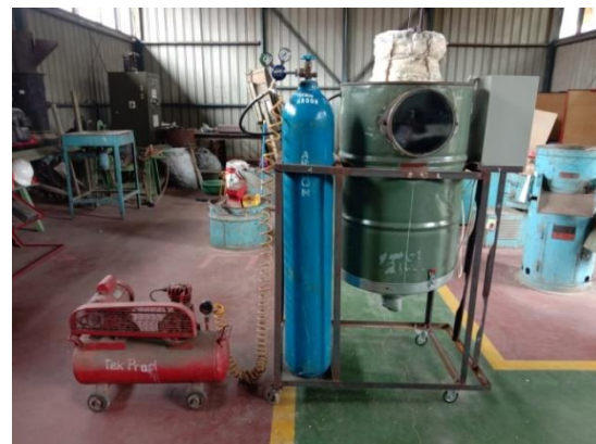
Gambar 6. Skematik Proses Atomisasi
