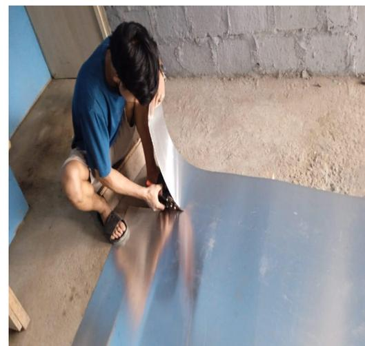
Gambar 3. Pemotongan plat
