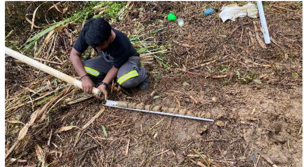
Gambar 4 : Kegiatan pekerjaan handbor lapangan
