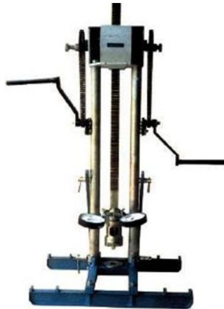
Gambar 1. Peralatan sondir Peralatan sondir yang digunakan kapasitas 2.5 ton.
