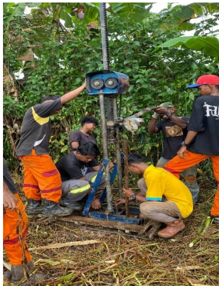
Gambar 3 : kegiatan sondir lapangan
