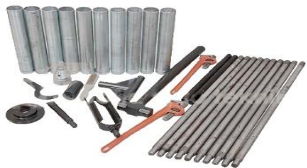
Gambar 2. Peralatan Handbor Peralatan handbor yang digunakan kapasitas 5 meter dengan diameter 2 inci.
