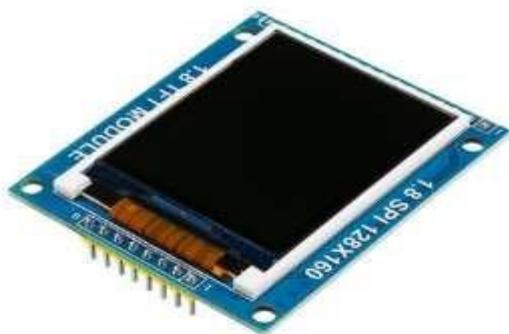
Gambar 7. LCD TFT 1,8 inci
