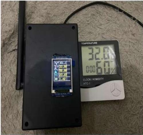
Gambar 12. Pengujian Sensor DHT11
