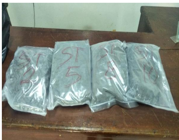
Gambar 1. Foto Sampel Sedimen setiap Stasiun
