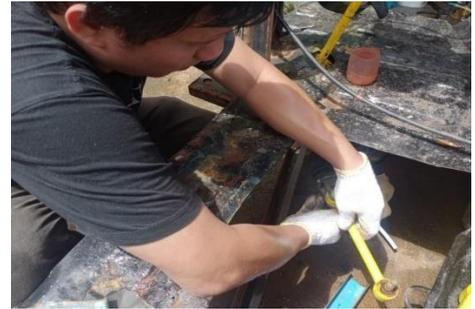
Gambar 8 Pemasangan *drag link* pada antara *rack* dan *center arm*
