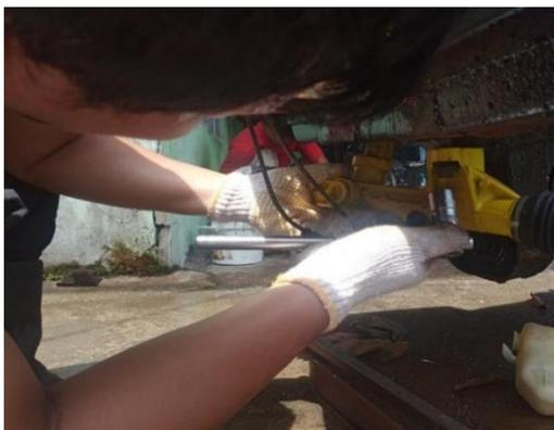
Gambar 7 Pemasangan Rumah *Rack And Pinion*
