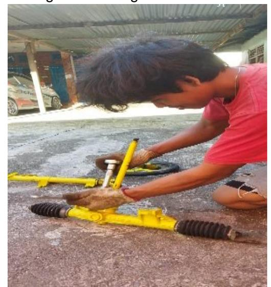
Gambar 4 Pemasangan *Rack And Pinion* Dengan Roda Gigi Kemudi
