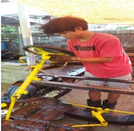
Gambar 5 Pemasangan roda gigi kemudi dengan *steering main shaft* dan *column tube*
