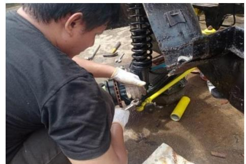
Gambar 10 Pemasangan *long tie rod* dengan *tie rod end*
