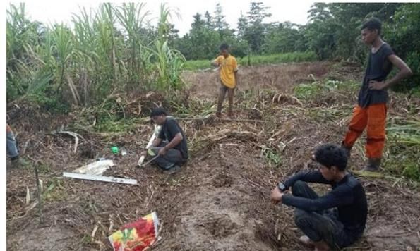
Gambar 1. Pembersihan Lokasi Sampling Pengambilan sampel dilakukan secara manual yaitu dengan cara menggali tanah dengan menggunakan linggis pada lokasi kadung jaya KM.9. Tanah digali dengan kedalaman kurang lebih 1,5 meter, tanah di ambil dan dimasukkan kedalam karung yang sudah disediakan, tanah yang diambil sebanyak 500 gram. Sampel diuji di Geotek PT. Sucofindo cabang Timika untuk pengujian shieve analysis.
