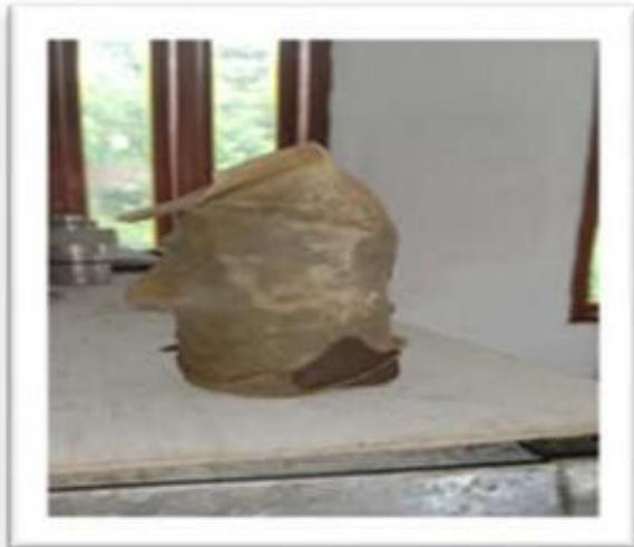
Gambar 1. Sampel uji yang telah terpasang membran karet
