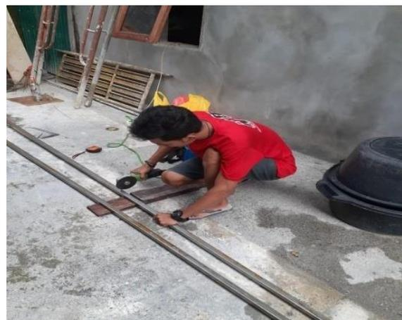
*Gambar 4. Pemotongan besi kotak*
