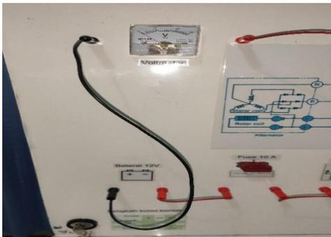
Gambar 25. penyambungan konektor ke baterai
