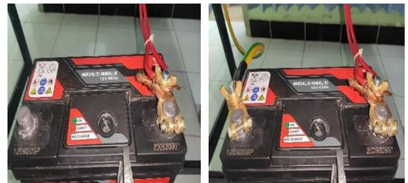
Gambar 21. urutan terminal pada baterai
