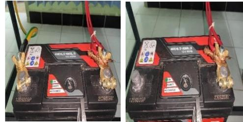
Gambar 14. Penyambungan konektor starter
