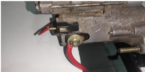
Gambar 12. Terminal pada motor starter
