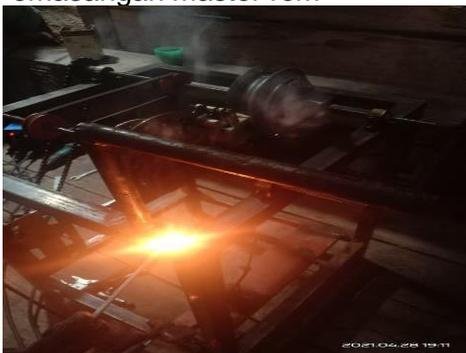
*Gambar 9. Pemasangan master rem*
