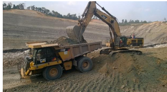
Gambar 2. Kegiatan pemuatan alat gali muat dan alat angkut pada PT. Bara Alam Utama.
