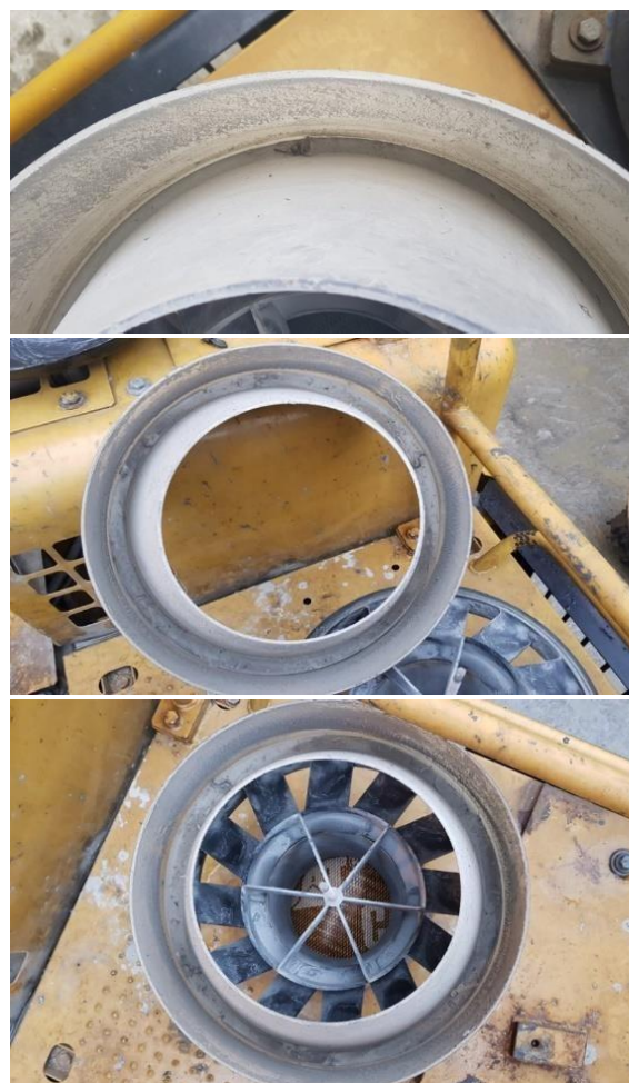
Gambar 5. Tampak dalam Pre-cleaner yang mengalami pengendapan debu.
