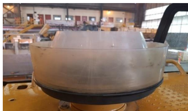
Gambar 6. Keretakan pada Pre Cleaner.
