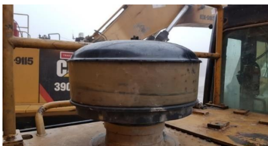
Gambar 4. Tampak luar Precleaner yang mengalami pengendapan debu.
