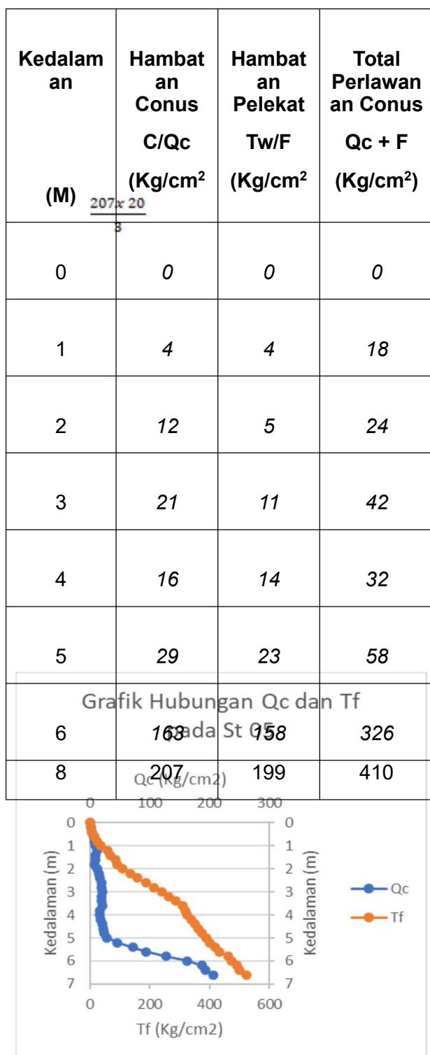
Gambar 3 Grafik Hubungan QC dan TF dengan Kedalaman pada Pengujian Sondir Perencanaan Gedung sekolah SMA Negeri 7 Timika Stasiun 05
