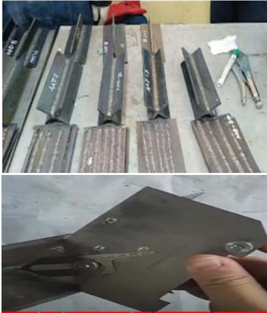
Gambar.13.pemeriksaan hasil pengelasan sudut dan ketinggian las
