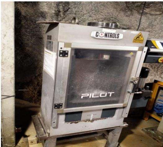
Gambar 2. Alat pengujian kuat tekan batuan area batch plant tambang bawah tanah GBC
