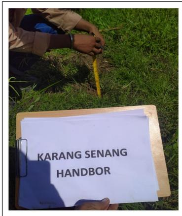
Dari gambar tersebut yaitu proses pengukuran sampel lubang *handbor* dengan itu kami hanya melakukan pengeboran hany 1 titik jadi setiap kami melakukan proses pengukuran hanya 4 kali pengukuran lubang *handbor*.
