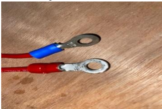
Gambar 2. Pemasangan skun kabel
