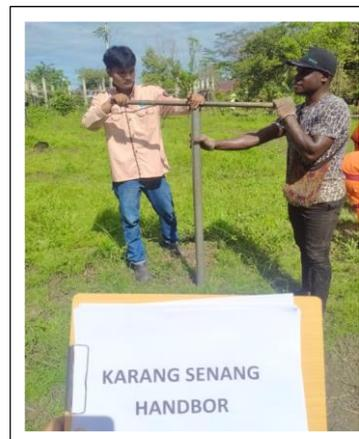
Dari gambar tersebut adalah proses pengambilan sampel di lapangan yaiitu pertamah kami mempersiapkan alat *handbor* dan melubangi sedikit tanah untuk memasuka pipa dan alat *handbor* ke dalam tanah
